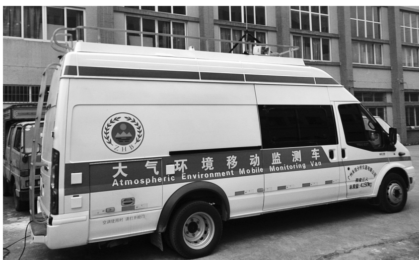
图为搭载了SPAMS车载式检测仪器的大气环境移动监测车。
