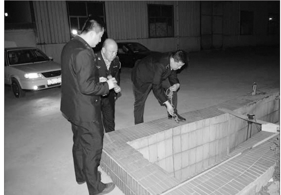
山东省平原县环保局深入开展环保专项检查行动,重点检查排污企业和城市污水处理厂治污设施运行情况、水质达标情况及城市污水管网、河流断面水质达标情况。图为环境监察人员夜查企业排污口,现场提取水样。 房德进 王莹莹摄
