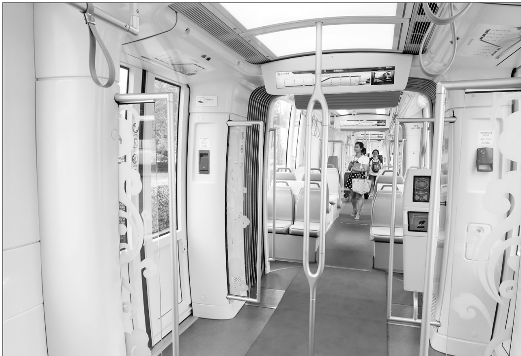
2015北京国际城市轨道交通展览会日前举办。图为市民正在参观100%低地板现代有轨电车。这种车辆只需在车站利用乘客上下车的时间进行充电,站与站之间完全没有接触网。而且,车辆运行中,对制动时产生的再生能量回收效率达85%以上,可实现能量的高效、循环利用。 本报记者邓佳摄
