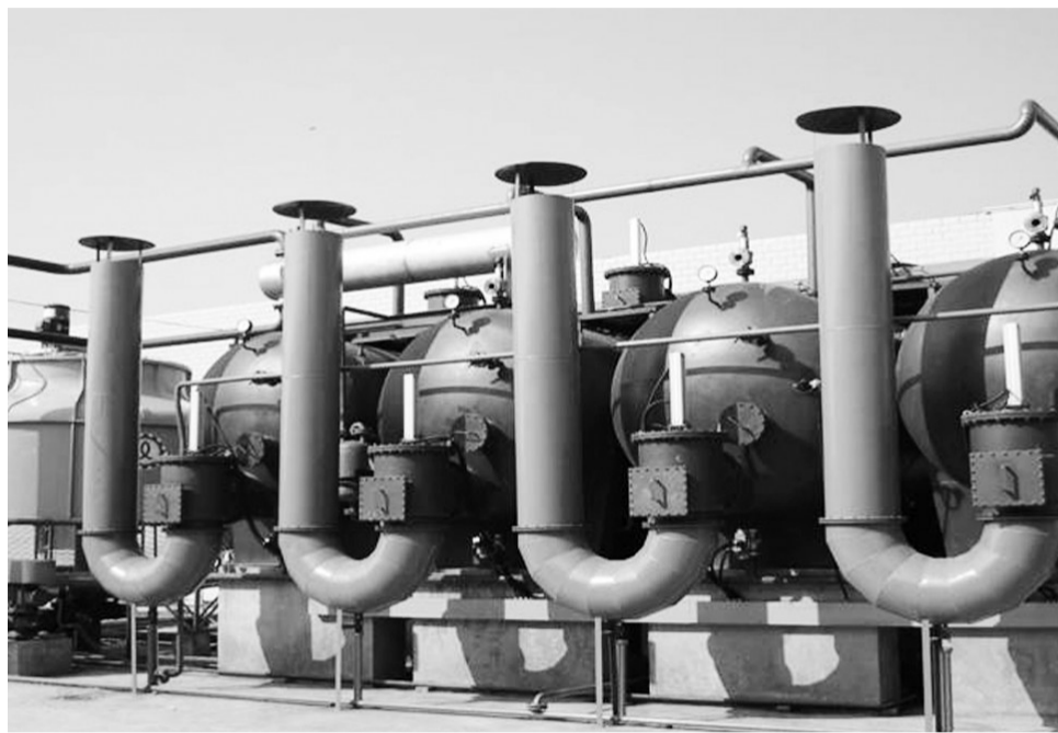
浙江诚信包装材料有限公司采用氮气保护再生颗粒活性炭吸附回收技术,共建成三期治理工程,年回收有机溶剂6000吨左右。图为浙江诚信包装材料有限公司颗粒活性炭吸附+氮气再生+冷凝回收工艺。 栾志强摄
