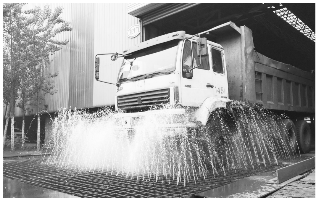
图为从天津天钢联合特钢有限公司全封闭料堆场驶出的卡车正在接受车轮净化装置冲洗。 任效良摄
