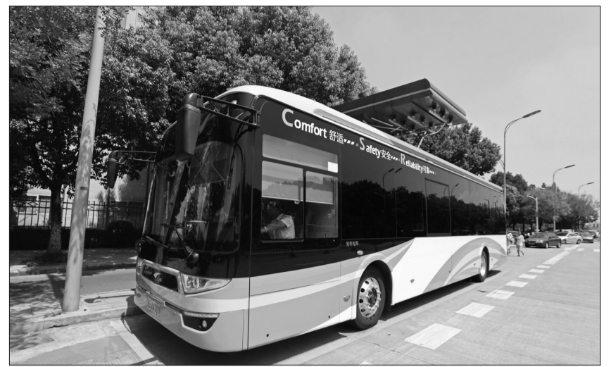
全球首条超级电容储能式现代电车运营示范线——196路公交线路近日在浙江省宁波市正式开通运营。这种电车低噪声,无污染,效率高达97%。 人民图片网供图
