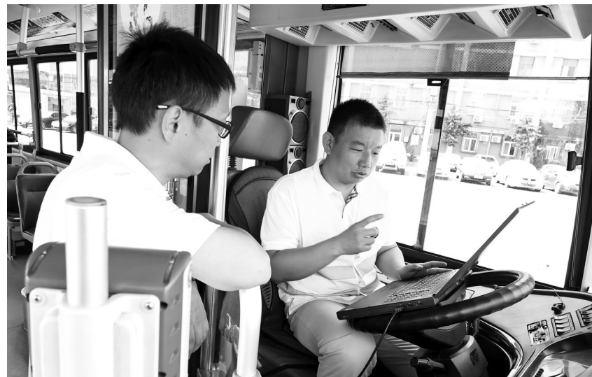
北京市为解决国四、国五重型柴油车低速低工况时氮氧化物排放较高的问题,制定了《车用压燃式、气体燃料点燃式发动机与汽车排气污染物限值及测量方法(台架工况法)》。通过实施这个标准,预计重型柴油车单车将削减60%的氮氧化物排放量。图为技术人员对升级改造的发动机进行循环标定。
