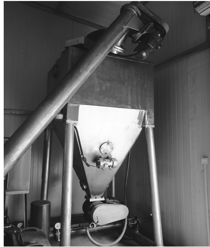
山东双赢节能环保科技有限公司研发的脱硫脱硝剂输送装置,大约占地3平方米,高2米。
