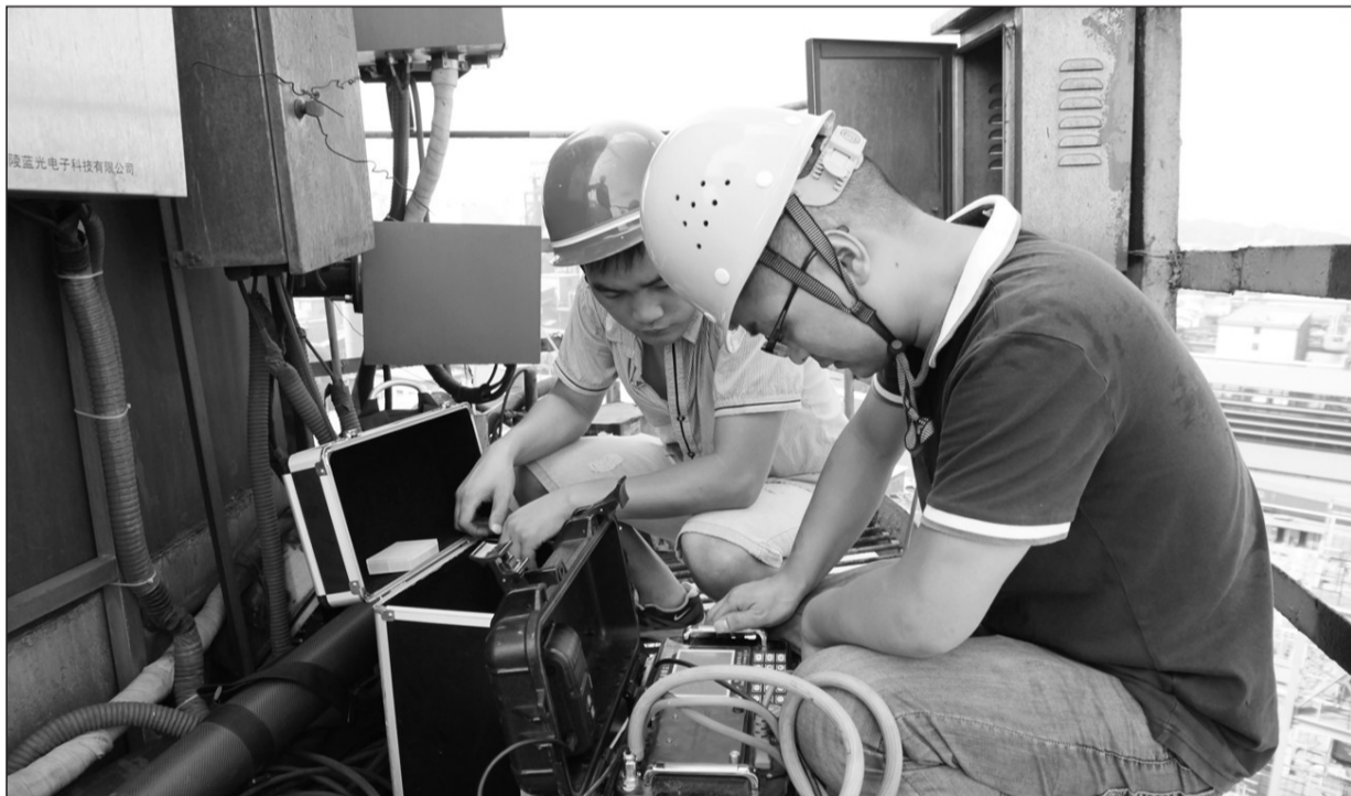
安徽省铜陵市环境监测中心站技术人员近日对国控重点污染源企业铜陵富鑫钢铁公司的烧结1号尾气烟筒进行季度监督性监测。图为技术人员在环境温度超过50℃的监测平台上工作。 王海宏摄
