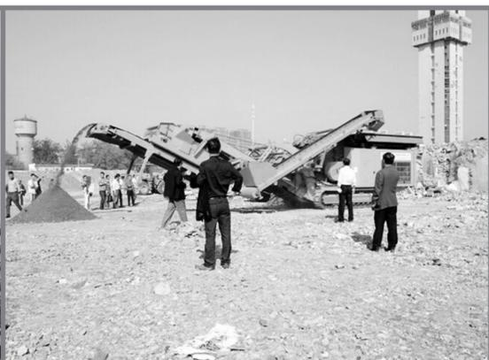
配置有无扬尘系统的履带式移动破碎站破碎建筑垃圾现场,油、电两用,不受工地条件限制,体积小,移动灵活,可对建筑垃圾进行就地粉碎,收尘封及云尘封系统可减少建筑垃圾粉碎及落料过程中产生的粉尘污染。
