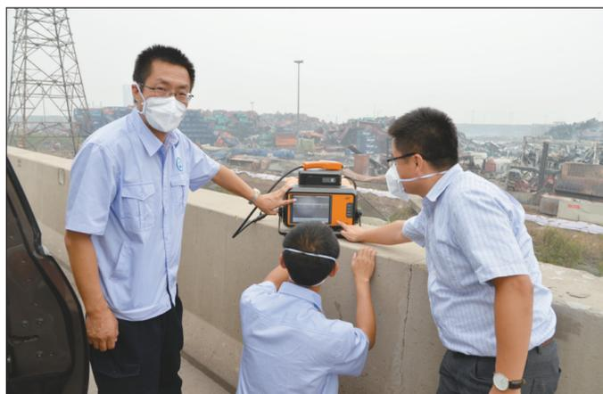
图为环境应急监测人员在距离爆炸事故点100米左右的地方采用便携式仪器,检测挥发性有机物。
