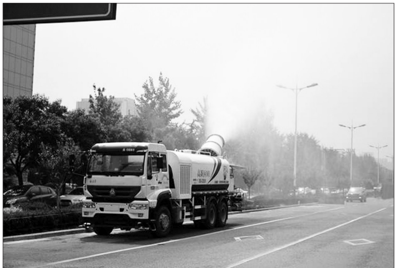
记者日前在山东省济南市高新区一条道路上看到,多功能抑尘车正在工作中,位于车尾的雾炮向空中喷出长约30米的水雾,水雾覆盖下的区域空气变得湿润、清新。据了解,高新区充分发挥新购置的两台多功能抑尘车的除尘降霾作用,对扬尘污染严重路段提高清扫频次,加大冲洗力度。 王文硕摄
