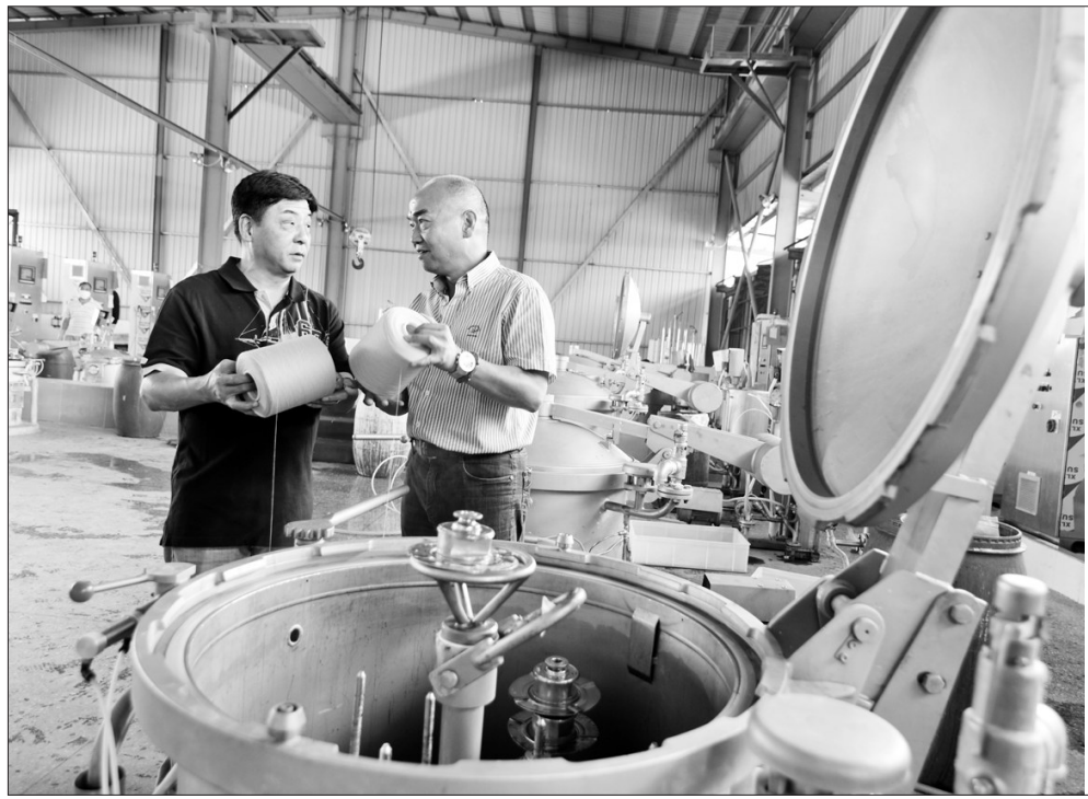
广东协祥盛染织有限公司通过科技节能技术改造,引进超低温比高温高压染色机,可节水68%,省电57%,减少蒸汽79%,染色剂用量减少46%以上,生产效率提升25%,解决传统染色机能耗高、排放大等问题。
