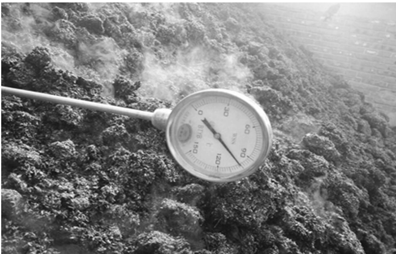
新型菌种升温快,48小时左右污泥堆体温度即可达到60℃~70℃。相较于传统好氧发酵技术,可使发酵温度低、发酵周期长、病原体和虫卵不能彻底杀灭的问题得到妥善解决,能实现污泥的无害化和稳定化处理。 资料图片
