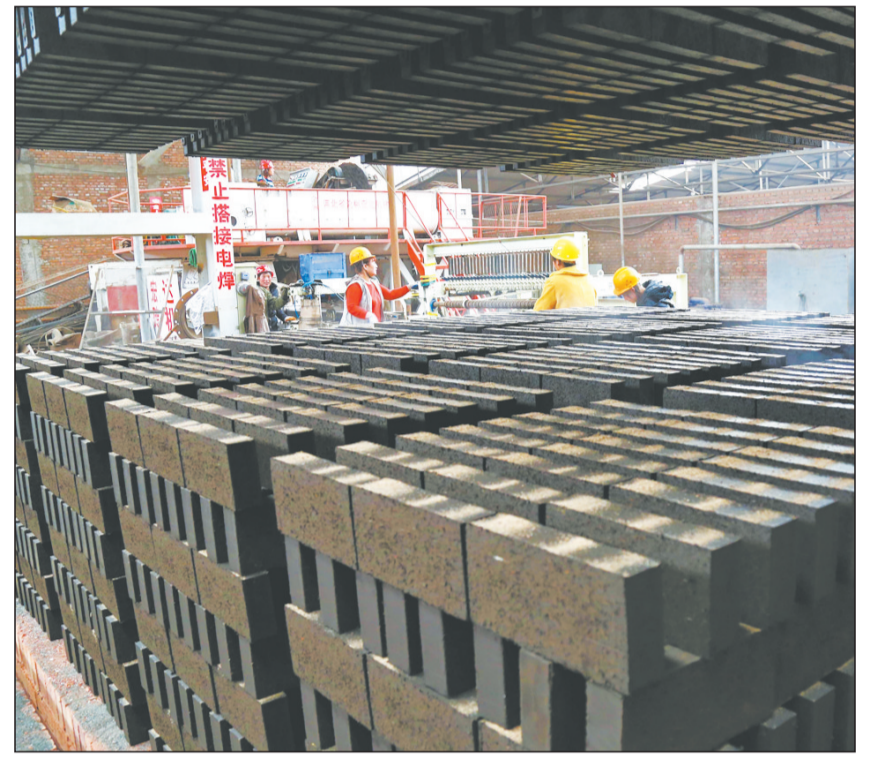
河北省青龙满族自治县引进的利用尾矿和页岩为原料、生产环保型建筑用砖项目近日投产。据介绍,项目年产尾矿页岩砖4000万块,预计销售收入4900万元。 新华社供图
