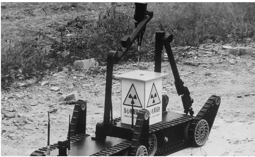
图为机器人正在将放射源放入铅罐中。 朱殿平摄
