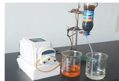
用高级催化氧化技术脱色降解甲苯胺废水实验,处理后化学需氧量去除率95%,脱色率达99%。
