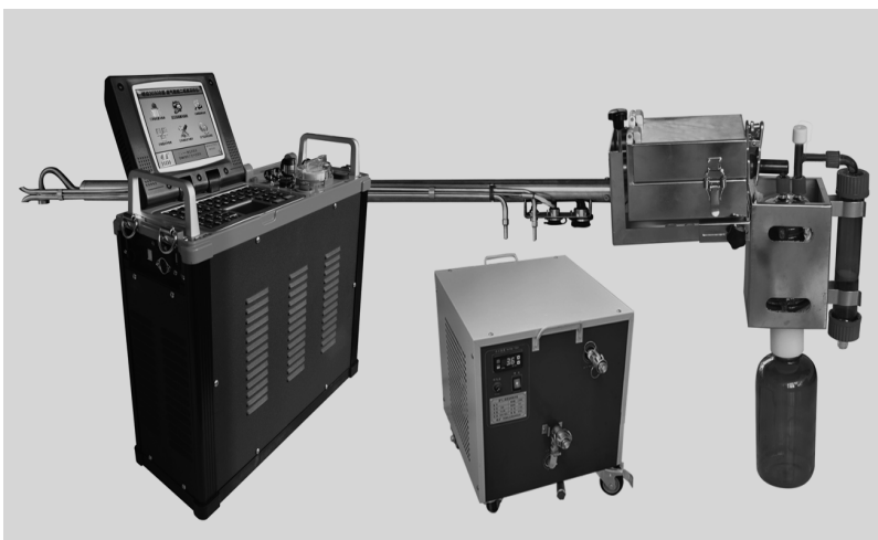
崂应3030B型 智能废气二噁英采样仪。
