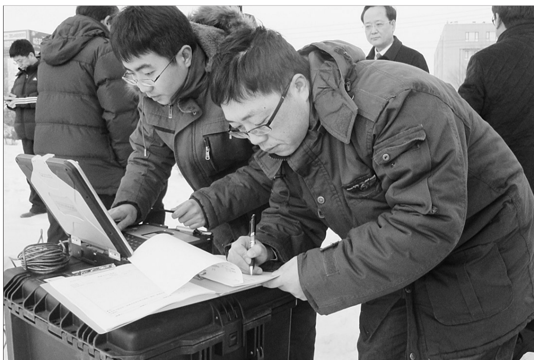
图为核与辐射安全中心监测应急人员使用就地伽玛谱仪进行地表核素分析。 姜瑛摄
