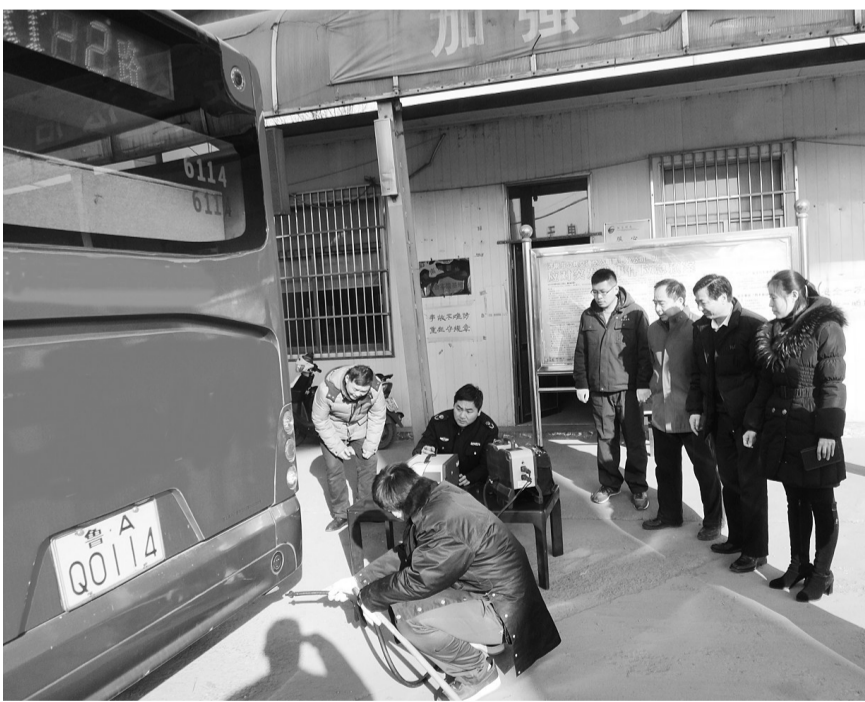
为改善环境空气质量,山东省济南市天桥区不断加大机动车污染防治力度,严查尾气超标。图为环境监测人员对济南市公交车车辆进行尾气检测。 袁清伟摄
