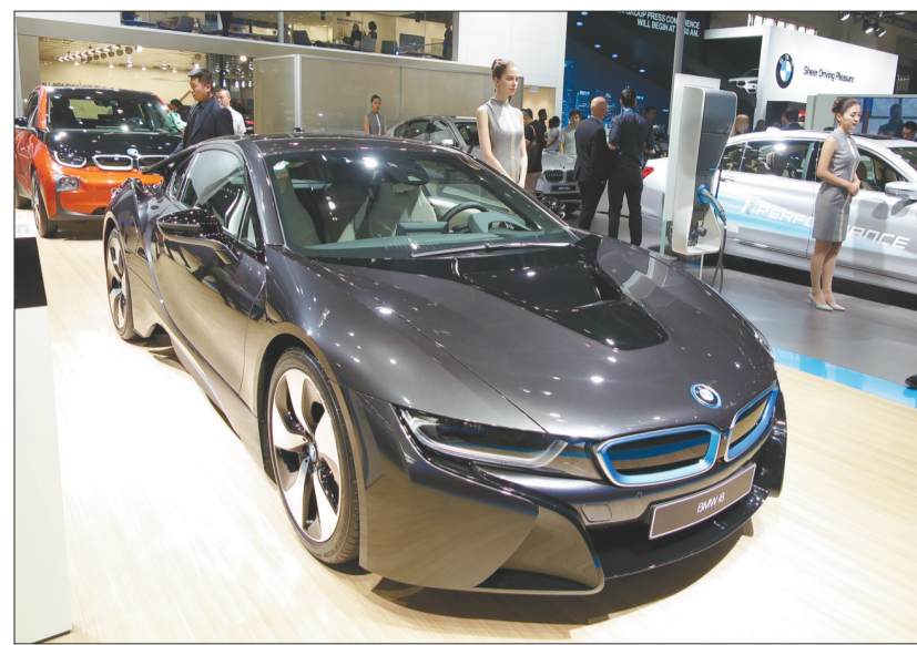
全新BMW i8的智能eDrive作为一种插电式混合动力系统,可以在4.4秒内使车从静止加速至100公里/小时,而耗油量仅2.1升/100公里。
