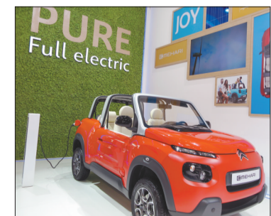
雪铁龙发布了E-MEHARI概念车,新车采用纯电力驱动,其搭载的电动机最大输出功率为68马力,匹配30kWh的电池组,最大续航里程为200公里,最高时速可达110公里/小时。
