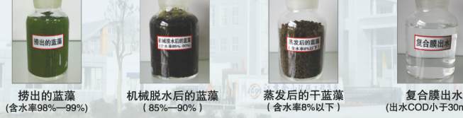
捞出的蓝藻(含水率98%~99%) 机械脱水后的蓝藻(85%~90%) 蒸发后的干蓝藻(含水率8%以下) 复合膜出水(出水COD小于30mg/L)
