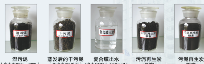
湿污泥(含水率80%~90%) 蒸发后的干污泥(含水率9%以下) 复合膜出水(出水COD小于30mg/L) 污泥再生炭(颗粒) 污泥再生炭(粉末)
