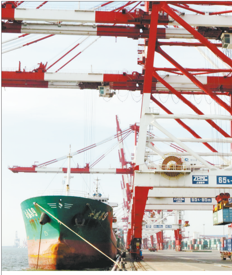
为推动节能减排工作，近年来，辽宁省营口港累计投资6400余万元，将码头的门式起重机由柴油机驱动改为电驱动。预计每年可减排一氧化碳677吨、碳氢化合物18吨、氮氧化物118吨。
