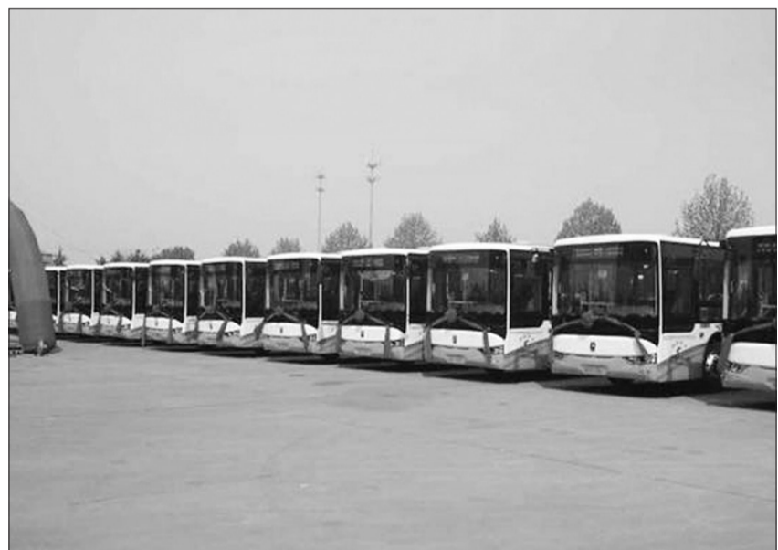
山东省滕州市首批40部气电混合动力公交车近日正式上线运营,可以比天然气车节省约25%~30%以上的燃料,大大减少大气污染物的排放,对改善城市空气质量具有重要意义。
