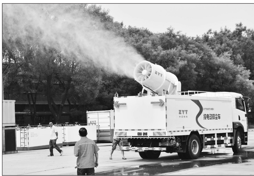
河南省濮阳市“纯电动抑尘车”日前通过国家级机动车质量检测机构的科技鉴定。据悉,此车在工作过程中,避免了以往的环境雾炮系统由燃油驱动而造成二次污染,在驱雾降尘的过程中具有良好的清除、抑制作用,实现了污染物零排放,具有显著的节能环保优势。 人民图片网供图
