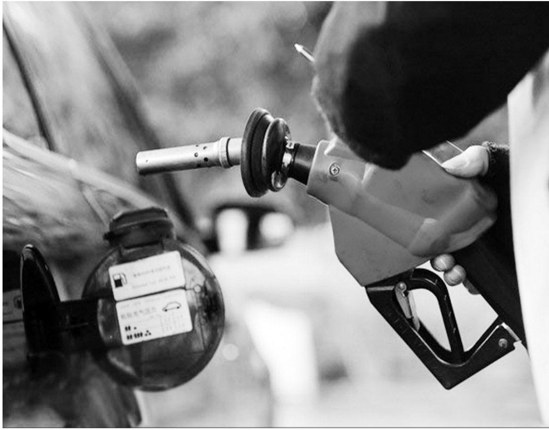
国VI标准在蒸发排放方面,将增加ORVR(车载加油油气回收系统)试验。
