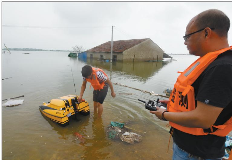
在新一轮强降雨来临之际,为应对湖北省第二大淡水湖梁子湖流域严峻防洪形势,湖北省对牛山湖实施破堤分洪,同时永久性退垸还湖。图为7月17日,武汉市环境监测中心会同江夏区环保局在分洪区布置3个监测点,利用无人监测船开展水质监测。本报记者邓佳摄
