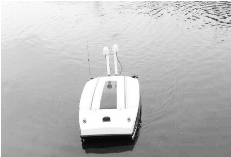
▲图为正在执行水质监测任务的采样无人监测船。
