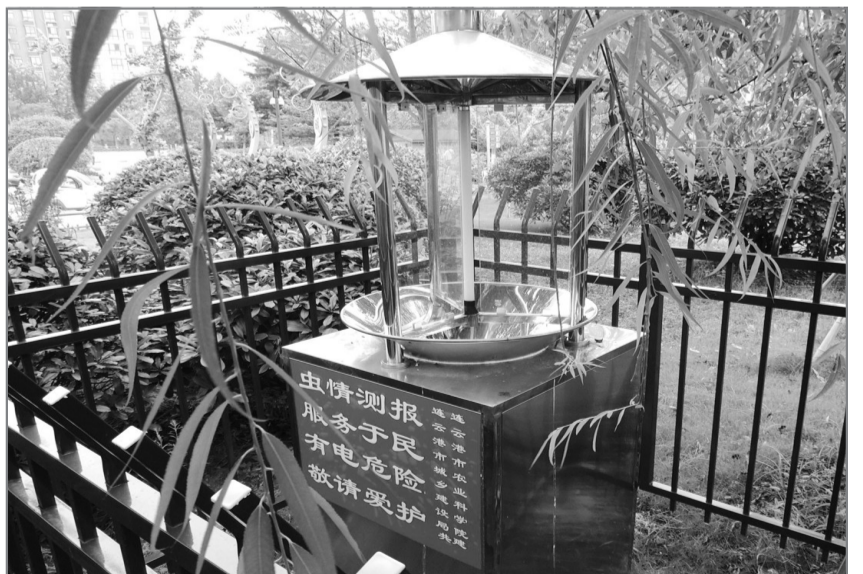
江苏省连云港市首台智能虫情测报仪日前在郁洲公园投运。这种智能虫情测报仪通过光控、雨控以及诱捕等原理,消灭飞虫并使其落入收集仓保存,有利于技术部门进行分析。通过大数据采集、分析虫情,可以及时进行防治,从而打造一个良好的生态环境。 人民图片网供图
