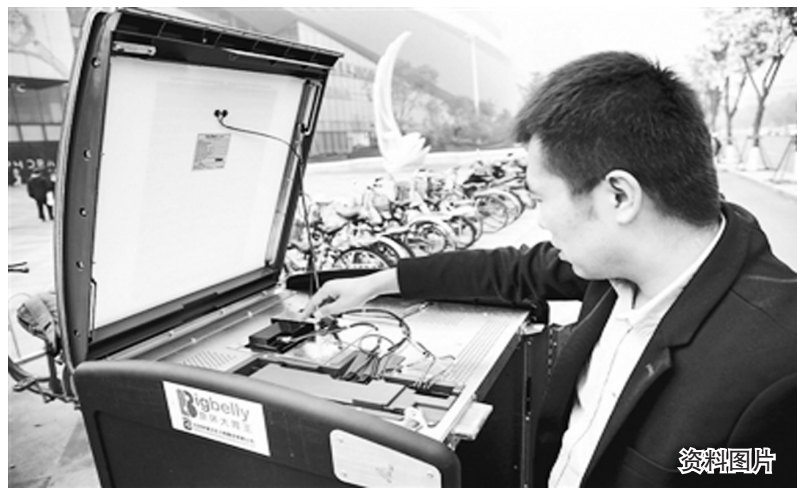
垃圾桶顶部的太阳能面板,正常照射一天储存的电能可让垃圾桶工作4天。
