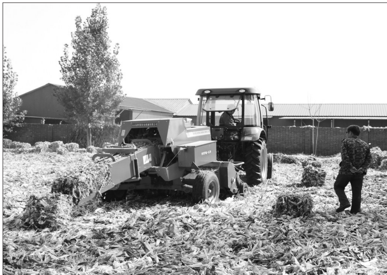
河北石家庄市鹿泉区鹿泉区寺家庄镇秸秆集中堆放点,通过机械化作用将玉米皮压缩打包成捆,然后这些成捆的玉米皮将被运往秸秆压块企业制成生物质清洁燃料。李玺摄
