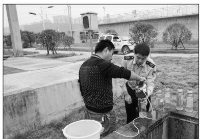
在企业总排口采集检测水样。
