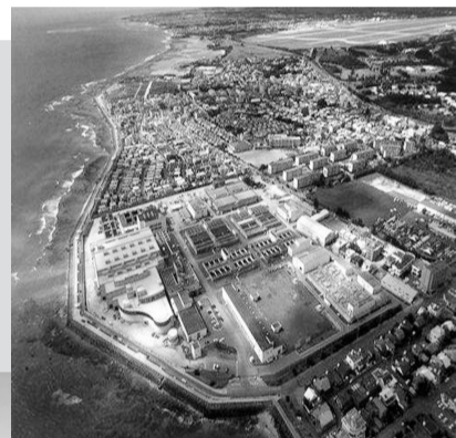
日本神户北古海水淡化厂为日本目前最大的海水淡化厂,日生产水量为4万吨,占地面积约1.2万平方米。海水经过反渗透处理生产淡水,且水质达到生活饮用水的标准。
