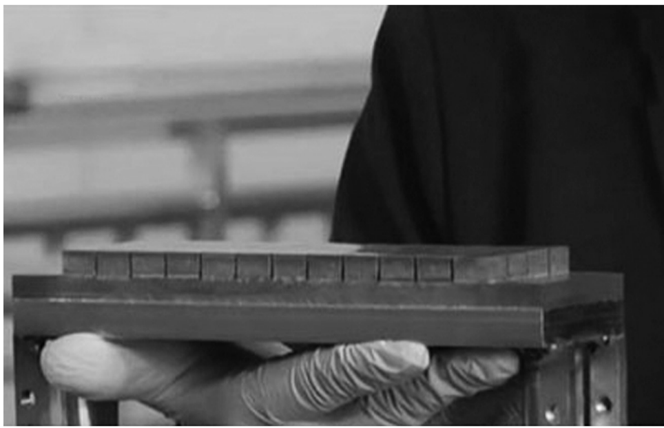
金属铍是放在反应堆内直接面对高温聚变材料的,如果它和铜合金的贴合不够紧密,就无法达到隔热防护的效果。中国科研人员想到了全新的办法。
