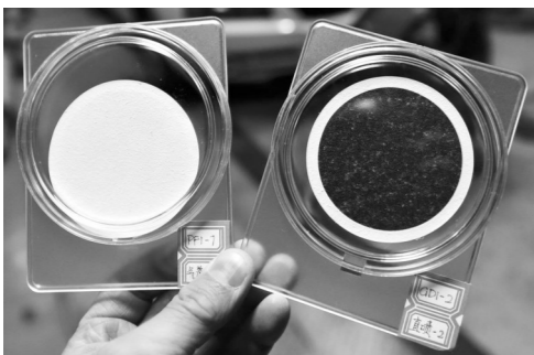
污染程度直观反映在滤纸上,右边变黑的滤纸的PM浓度接近5000微克/立方米。 本报记者史小静摄
