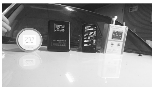
4个便携式测量仪在同一外环境下显示出4个不同结果。
