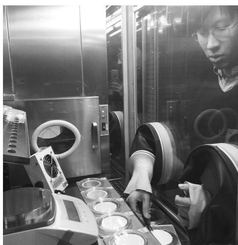
实验在“恒温恒湿称重箱”中进行滤膜称重法测量。
