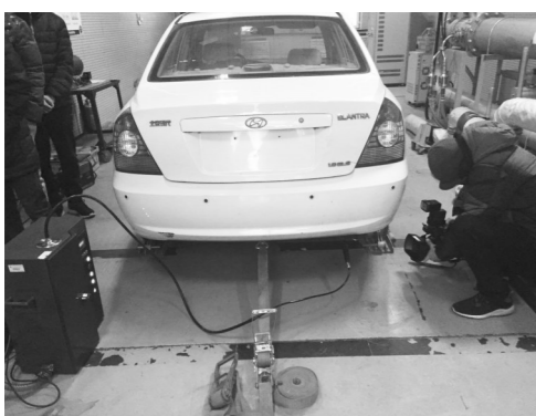
利用低压电晕分离器系统测量气溶胶颗粒数量。
