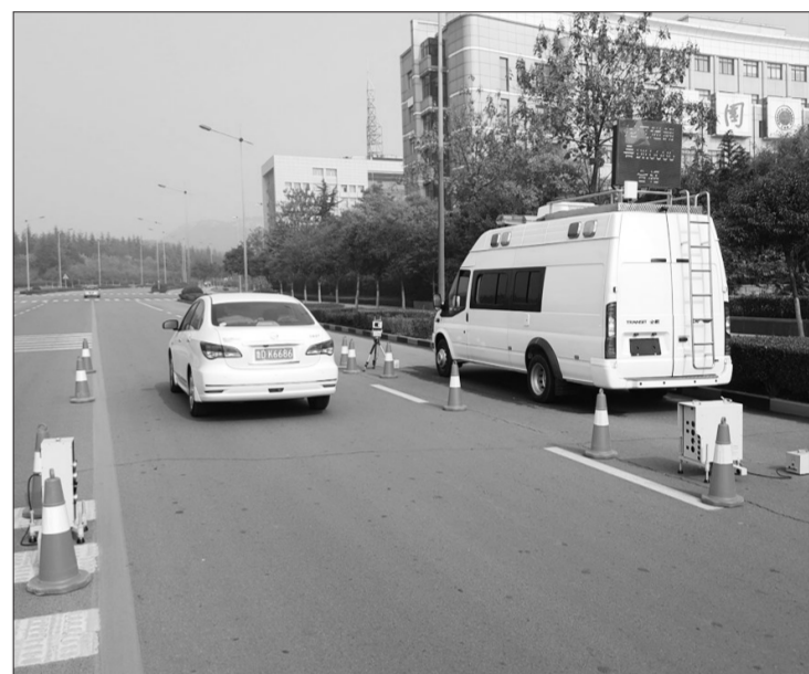
山东省枣庄市首个移动式机动车尾气遥感监测系统日前正式交付使用,加入日常监测行列。监测系统在0.8秒内即可完成对行驶中机动车所排放的一氧化碳、碳氢化合物、氮氧化物、颗粒物等大气污染物浓度的监测,并判定被监测车辆尾气是否超标,同时通过高清摄像头识别车辆牌照等车辆信息,辅助查处环境违法车辆。李鹏 王文硕摄影
