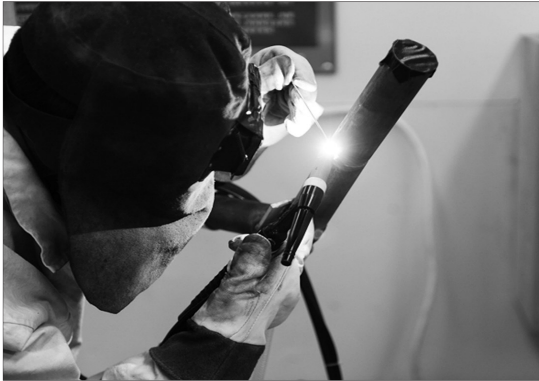
图为参赛人员正在对不锈钢小管进行斜45°向上立焊对接。中国核工业二三建设有限公司供图
