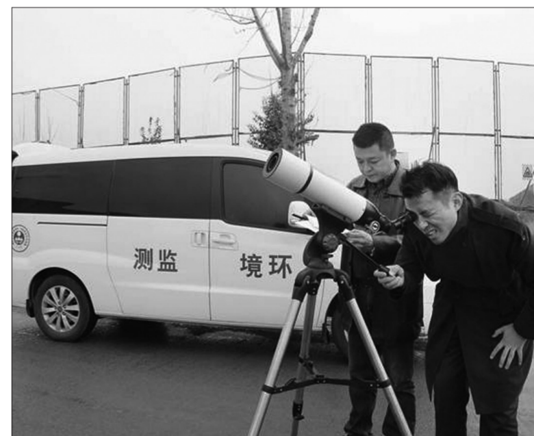
山东省济宁市任城区突出“压煤、抑尘、治车”三大重点,以“稳、准、狠”措施治理大气污染顽疾,加快改善环境空气质量。图为任城区环境监测人员利用烟气黑度测试仪测试中电电力公司烟气排放情况。
