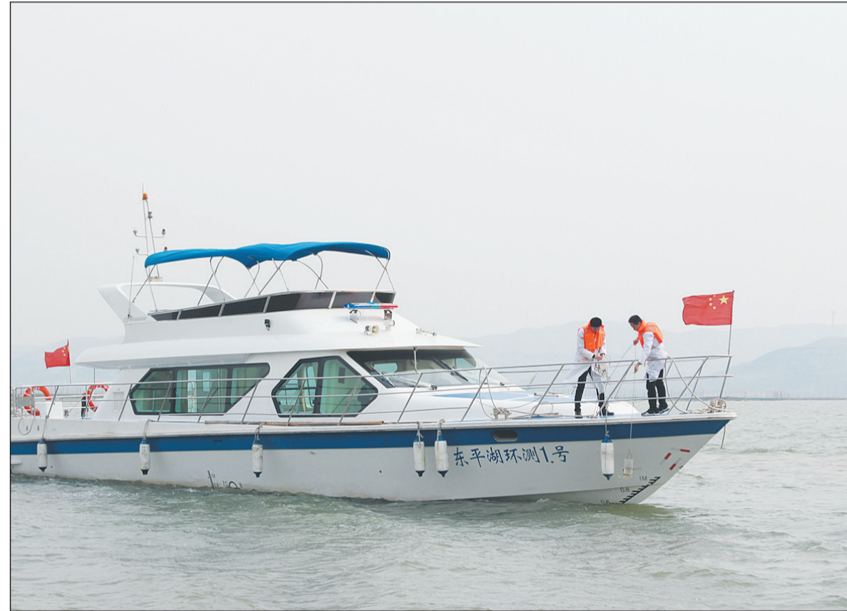
山东省泰安市首艘环保监测船“东平湖环湖1号”日前投入运行。监测船排水量22.04吨,动力210千瓦,定员21人,配备了部分环境监测设施。下一步,泰安市环保部门将在船上增设工作平台和实验室,以便在船上完成水样实验分析,快速掌握水质情况。
