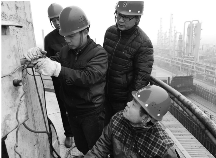
图为执法人员正在对石家庄市井陘矿区内的新世纪焦化集团焦炉烟气排放进行手工监测。张铭贤摄
