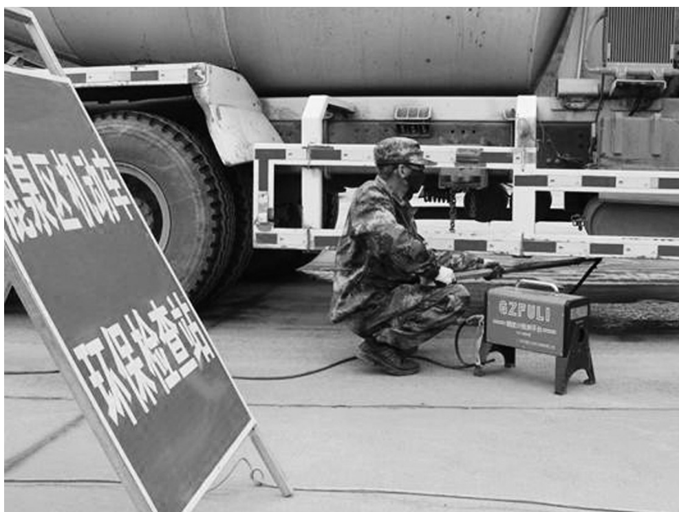
石家庄市鹿泉区机动车环保检查站内,技术人员正在对重型柴油车进行尾气检测。 李奎尧摄
