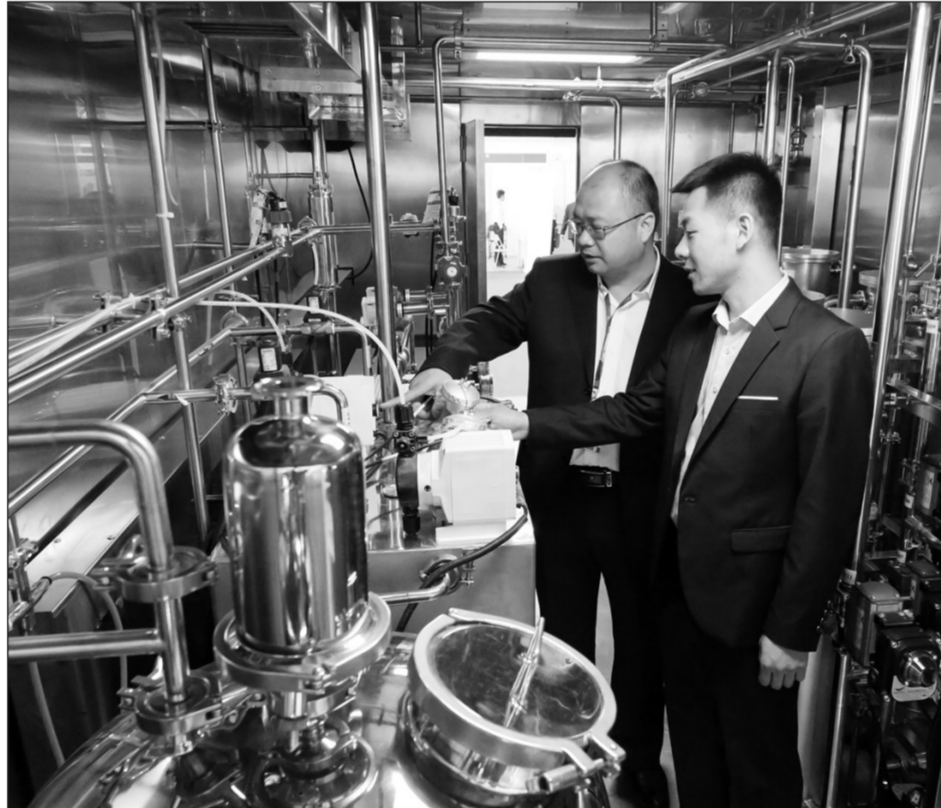
由北京清核核华科技有限公司研发、具有自主知识产权的放射性废液处理装置日前亮相第十二届中国国际核工业展览会上。这一装置用于核电厂常规放射性废液处理以及核电厂、核设施严重事故条件下放射性废液的应急处理。 本报记者邓佳摄
