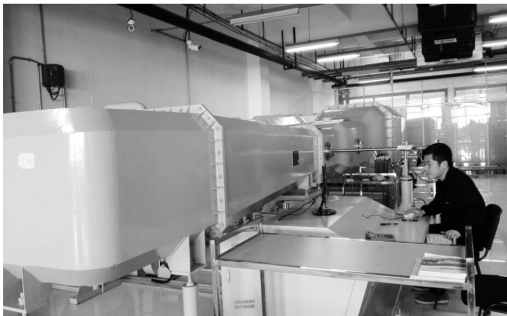
图为可模拟烟气在循环过程中流速的仪器风洞,可提高保证数据采集的准确性。
