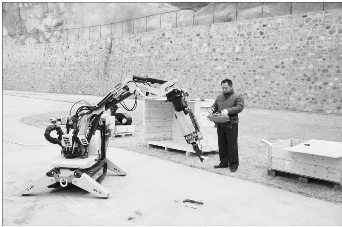
一旦发生辐射安全事件,耐辐射机器人可以第一时间到达现场,将放射源抓取到安全容器中。王培摄
