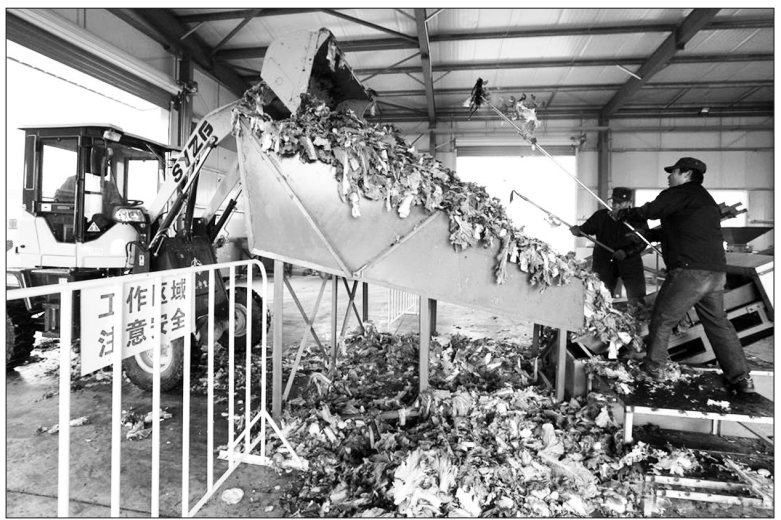
山东省枣庄市在峄城区大桥蔬菜批发市场附近建设的农业废弃物生化处理站近日投入使用。这个生化处理站对蔬菜废弃物进行粉碎压榨、烘干、高温发酵等生化处理后,将其制造成有机肥料、青贮饲料,每年可处理蔬菜废弃物两万多吨,能生产达到国家标准的有机肥料3000多吨、青贮饲料500多吨,从根本上解决了当地蔬菜废弃物难以有效处理的问题。
