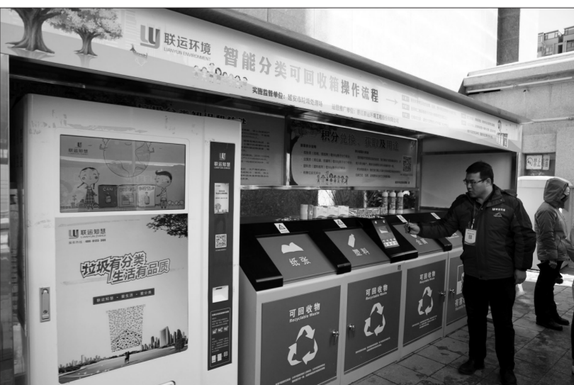
在陕西省延安市紫五东方便小区,智能垃圾分类回收箱投入使用。据了解,这款垃圾智能回收箱包括智能餐厨和其他垃圾回收箱,垃圾袋自动投放机等设备,实现了智能感应投放,自动满溢报警,而且密封好,无臭气外露,还自带精确称重装置,通过云平台数据联接,实现投放数据管理,回收更智能。 李涛摄
