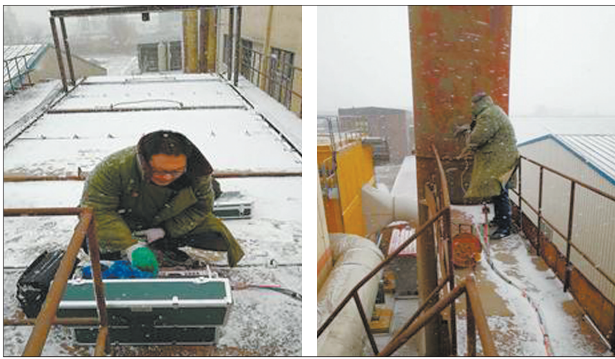
胶州环境监测人员冒雪进行企业锅炉废气采样。 刘东浩摄
