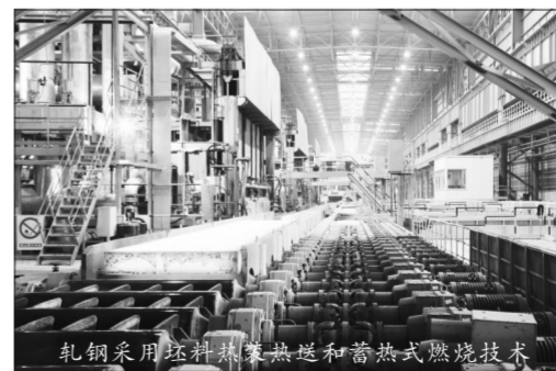
轧钢采用坯料蓄热和蓄热式燃烧技术
