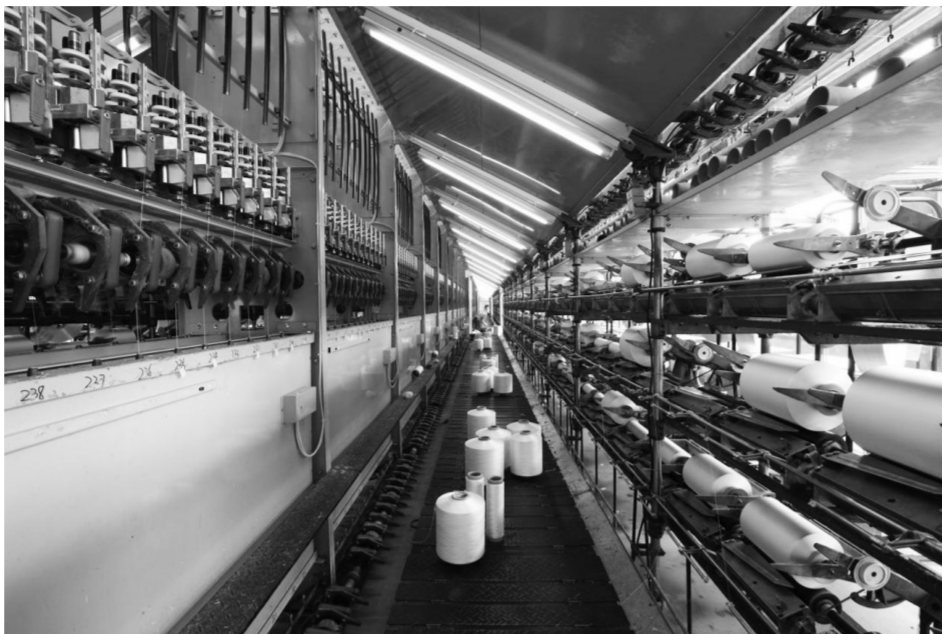
图为废塑料高值化利用生产高性能纤维生产线。
