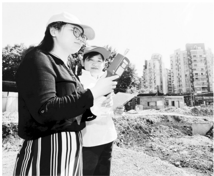
高温下环境监测员带着激光粉尘测试仪采集当天的空气质量数据。
