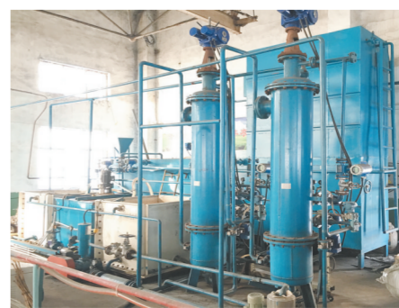
课题研发的腈纶废水高聚物截留成套设备
