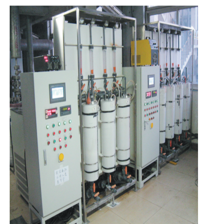
课题研发的丙烯酸丁酯废水有机酸回收设备
